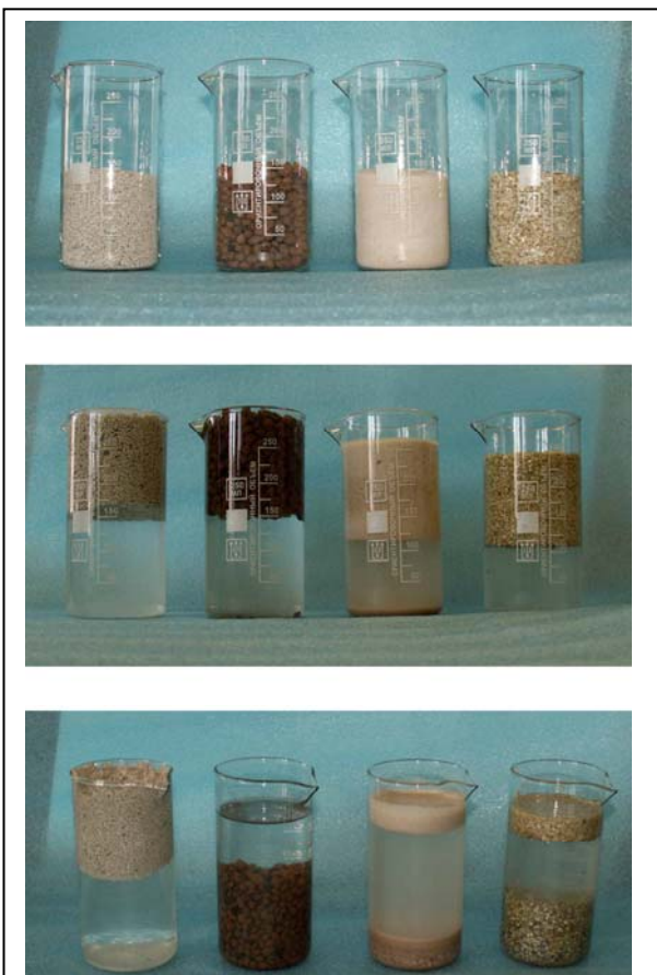
Рис. 2.1. Материалы (слева-направо): Пенокерам, керамзит, вспученный перлит и вспученный вермикулит. Верхний рисунок – до эксперимента, средний – залиты водой, нижний – после месяца выдержки.
