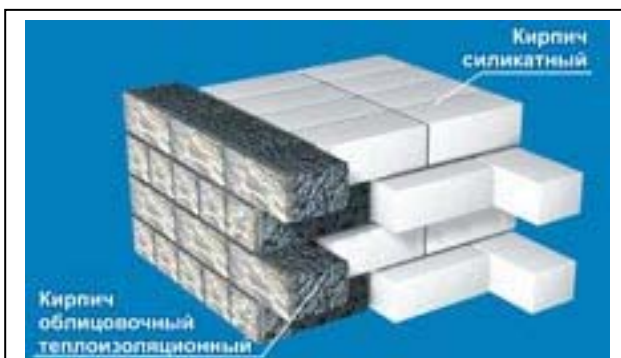
Рис. 1. Кладка стены толщиной 640 мм - R=2,852 - 3,22 \text{ м}^2 \cdot \text{град}/\text{Вт} . Кирпичная кладка из силикатного кирпича (по ГОСТу 379) имеет коэффициент паропроницаемости 0,11 \text{ мг}/\text{м}^2 \text{ ч} , а полистиролбетон марки 200 имеет коэффициент паропроницаемости 0,12 \text{ мг}/\text{м}^2 \text{ ч} . Фото с сайта http://articles.stroybm.ru/komfort/20000824163600/index.html
